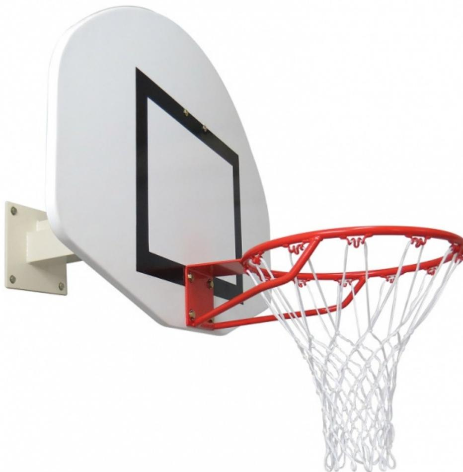
But de basket mural fixe conforme à la norme NF EN 1270. Départ 0,60 m. Structure en acier électrozingué plastifié blanc. Supports panneau et mural en plat d'acier ép. 4 mm. Livré avec panneau en fibre de verre 1,12 X 0,775 m, cercle en acier plein 18 mm avec 2 renforts et filet polypropylène 5 mm.
