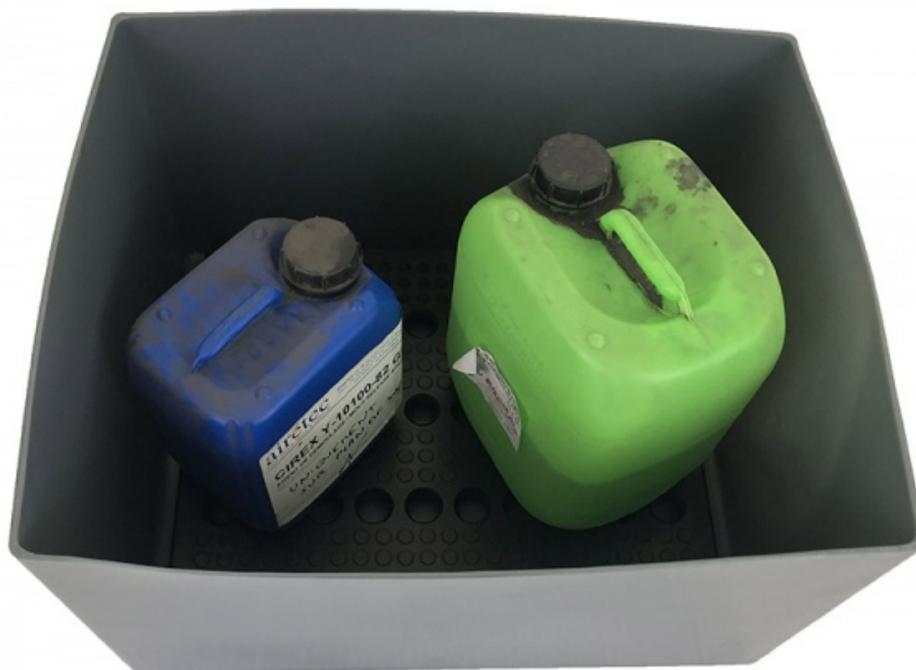
Bac de rétention avec caillebotis fabriqué en polyéthylène. Ce produit bénéficie d'une capacité de rétention de 83 L. Pour le stockage et la manipulation en toute sécurité de flacons et bidons susceptibles de fuir. Bac en polyéthylène (PEHD) de couleur jaune ou gris et caillebotis en polyéthylène (PEHD). Anti-ultraviolets. Fabriqué en France. Volume : 83 L. Dims (cm) : L 56 x P 45 x H 33. Poids à vide : 5,5 kg. Garantie 12 mois.
