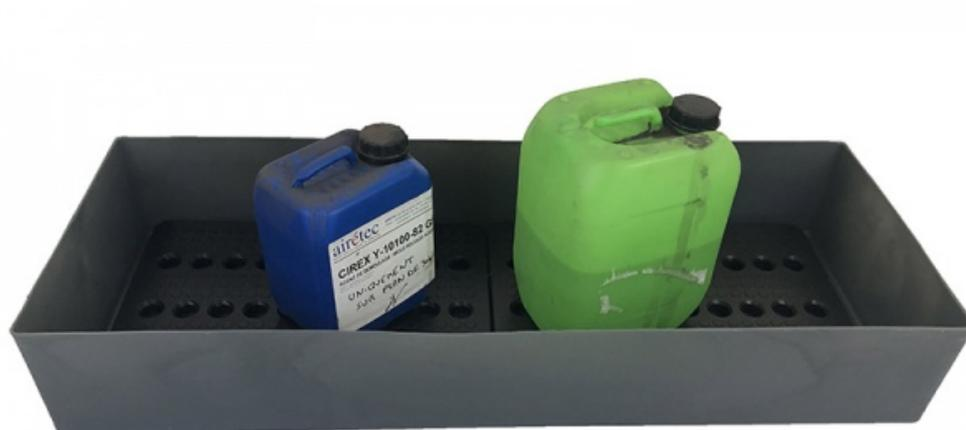
Bac de rétention avec caillebotis fabriqué en polyéthylène. Ce produit bénéficie d'une capacité de rétention de 70 L. Pour le stockage et la manipulation en toute sécurité de flacons et bidons susceptibles de fuir. Bac en polyéthylène (PEHD) de couleur jaune ou gris et caillebotis en polyéthylène (PEHD). Anti-ultraviolets. Fabriqué en France. Volume : 70 L. Dims (cm) : L 105 x P 40 x H 17. Poids à vide : 5,6 kg. Garantie 12 mois.
