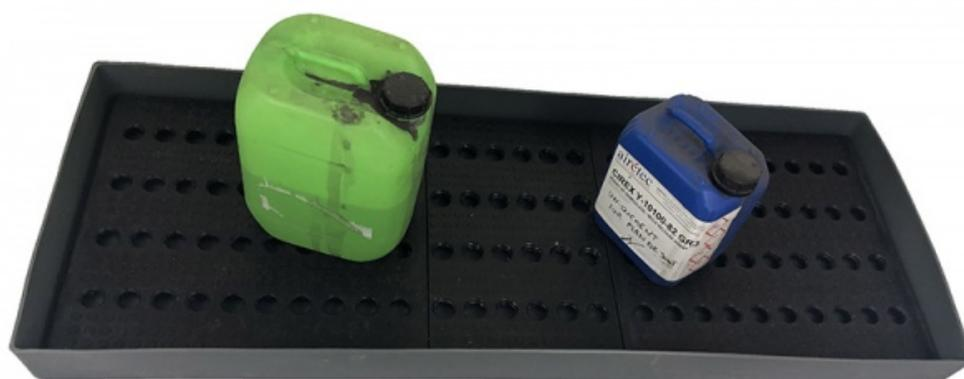
Bac de rétention avec caillebotis fabriqué en polyéthylène. Ce produit bénéficie d'une capacité de rétention de 60 L. Pour le stockage et la manipulation en toute sécurité de flacons et bidons susceptibles de fuir. Bac en polyéthylène (PEHD) de couleur jaune ou gris et caillebotis en polyéthylène (PEHD). Anti-ultraviolets. Fabriqué en France. Volume : 60 L. Dims (cm) : L 130 x P 50 x H 9. Poids à vide : 7,6 kg. Garantie 12 mois.
