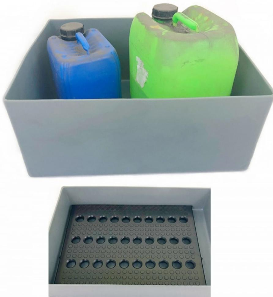
Bac de rétention avec caillebotis fabriqué en polyéthylène. Ce produit bénéficie d'une capacité de rétention de 44 L. Pour le stockage et la manipulation en toute sécurité de flacons et bidons susceptibles de fuir. Bac en polyéthylène (PEHD) de couleur jaune ou gris et caillebotis en polyéthylène (PEHD). Anti-ultraviolets. Fabriqué en France. Volume : 44 L. Dims (cm) : L 50 x P 40 x H 22. Poids à vide : 3,5 kg. Garantie 12 mois.
