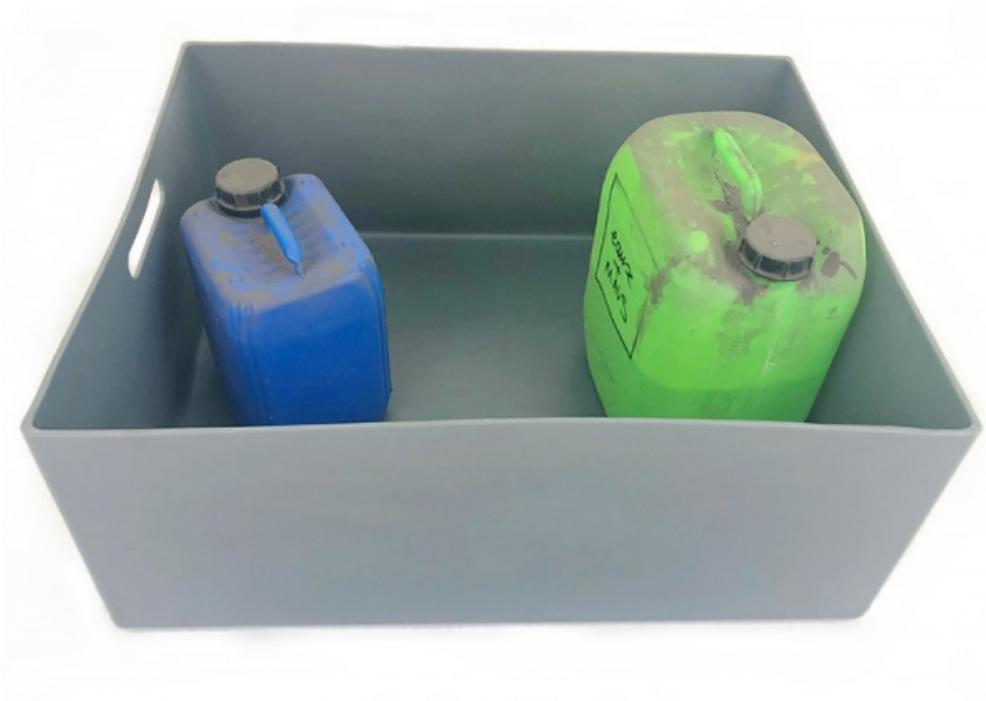
Bac de rétention fabriqué en polyéthylène. Ce produit bénéficie d'une capacité de rétention de 25L. Pour le stockage et la manipulation en toute sécurité de flacons et bidons susceptibles de fuir. Bac en polyéthylène (PEHD) de couleur jaune ou gris. Anti-ultraviolets. Fabriqué en France. Volume : 25 L. Dims (cm) : L 58 x P 40 x H 11. Poids à vide : 1,8 kg. Garantie 12 mois.
