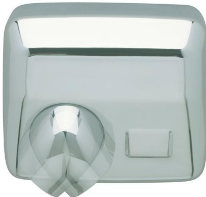
Sèche-main antivandalisme automatique, capot acier chromé brillant. Buse orientable sur 360 degrés. Vitesse de sortie d'air : 108 km, h. Alimentation : 230 V - 50, 60 Hz. Puissance nominale : 2 500 W. Débit d'air : 270 m<sup>3</sup> h. Appareil protégé contre les surchauffes et les sur tensions. Classe I. IP21. Capot en acier embouti. Garantie 3 ans. Dims (cm) : L26,5 X P20 X H24.
