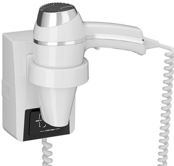
Sèche-cheveux avec prise rasoir moderne et compact. Utilisation très facile. Puissance 1400 W. 2 configurations de séchage. Débit d'air 60 et 95 h. IP21. Installation dans le volume 3. Isolation électrique classe II. Prise rasoir universelle. Alimentation 230 V 50-60 Hz. Produit français. Coloris blanc.
