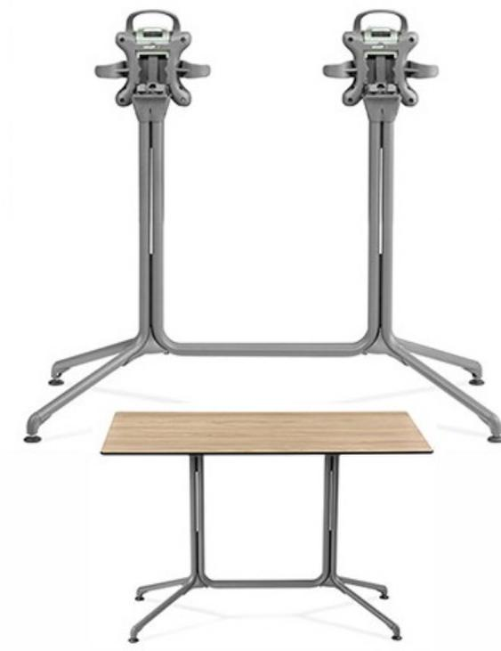
Pied de table double basculant avec système de frein. Système de poignée de manipulation breveté. Pieds encastrables pour faciliter le rangement. Tubes en acier galvanisé Ø 25 X 1,5 mm. Traitement par passivation et finition peinture 100% polyester, coloris titane. Assure une très bonne résistance à la corrosion. Pieds équipés de 4 patins réglables et ajustables pour une meilleure stabilité. Pièces plastiques renforcées en polyamide. 4 crochets pour sacs sous le plateau. Montage facile.
