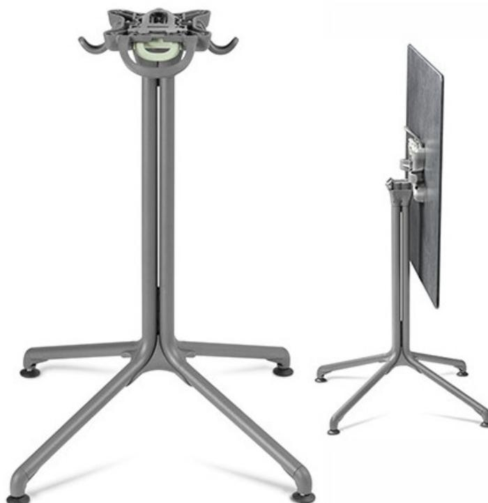
Pied de table central basculant avec système de frein. Système de poignée de manipulation breveté. Pieds encastrables pour faciliter le rangement. Tubes en acier galvanisé Ø 25 X 1,5 mm. Traitement par passivation et finition peinture 100% polyester, coloris titane. Assure une très bonne résistance à la corrosion. Pieds équipés de 4 patins réglables et ajustables pour une meilleure stabilité. Pièces plastiques renforcées en polyamide. 4 crochets pour sacs sous le plateau. Montage facile.
