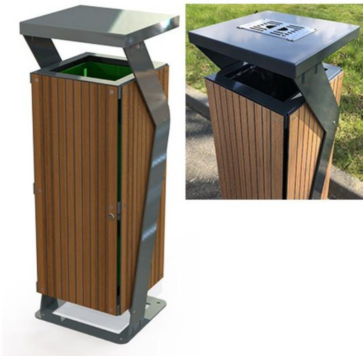
Une corbeille avec cendrier moderne et très valorisante. Structure en plat d'acier ép. 6 mm. Couvercle en tôle d'acier ép. 2 mm. Platine en tôle d'acier ép. 5 mm. Acier électrozingué. Finition peinture thermolaquée (RAL au choix). Panneaux d'habillage en stratifié compact ép. 5 mm, gage de durabilité, de robustesse avec un entretien facile. Cendrier en inox AISI 304L. Fixation par chevillage sur sol béton (kit fourni). Dims (cm) : L 38 X P 36,5 X H 106,5. Poids : 30,5 kg.
