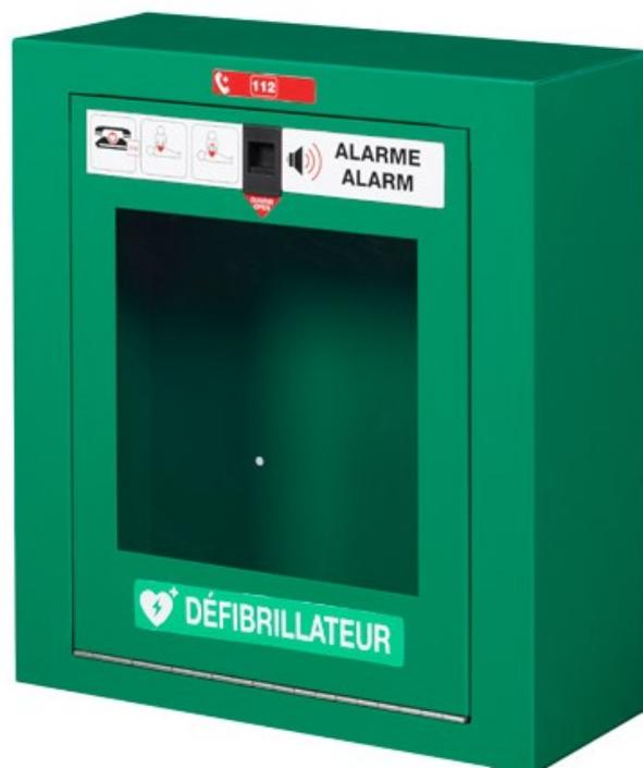
Le boîtier idéal pour ranger un défibrillateur dans les vestiaires, infirmeries, ateliers, ? Corps en acier poudré époxy. Fermeture par poignée coulissante plastique. Crochet intérieur pour maintien de la trousse de secours (non fournie). Porte avec vitre acrylique transparente. Alarme sonore (100Db) avec clé d'activation. Plaque autocollante informative. Dims (cm) : L38 X P16 X H42. Poids : 4,15 kg.
