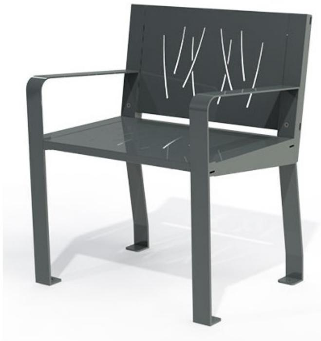
Un fauteuil au design épuré et moderne avec de belles finitions. Structure en plat d'acier ép. 8 mm. Accoudoirs en tôle d'acier ép. 5 mm. Panneaux décor assise et dossier avec découpe laser en tôle d'acier ép. 2 mm. Acier électrozingué. Finition peinture thermolaquée selon RAL. Fixation sur sol béton par chevillage. Poids : 29,2 kg. Dims (cm) : L67 x P48 x H82. Livré en kit à monter.
