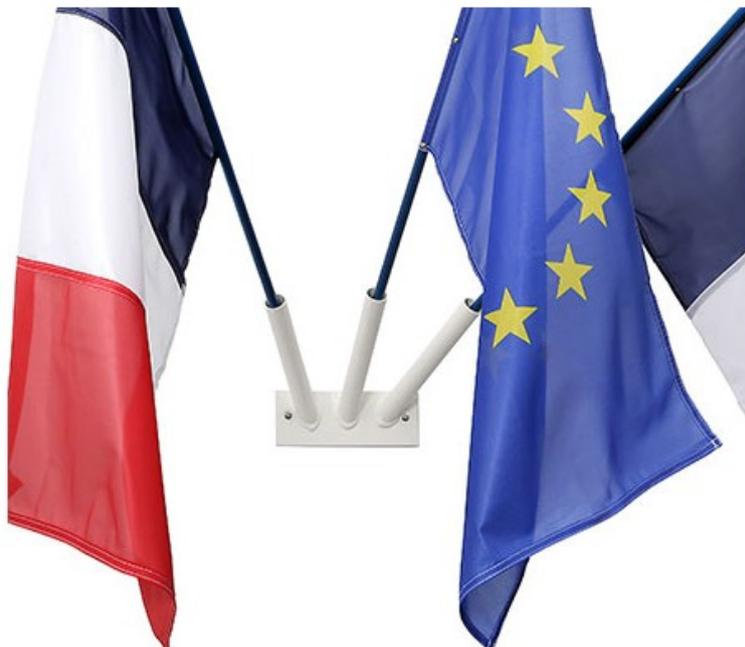
Supports conçus pour la pose de drapeaux à insérer directement dans la buse ou de mâts de façade recouvrant la buse. Réalisés en acier laqué blanc. Buse hauteur 21 cm, diamètre 26 mm. Inclinaison 30°. Platine de fixation murale : 20 x 10 cm. Livrée pré-percée (entraxe 17 cm).
