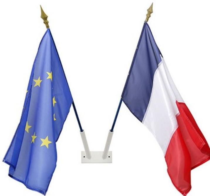
Supports conçus pour la pose de drapeaux à insérer directement dans la buse ou de mâts de façade recouvrant la buse. Réalisés en acier laqué blanc. Buse hauteur 21 cm, diamètre 26 mm. Inclinaison 30°. Platine de fixation murale : 20 x 10 cm. Livrée pré-percée (entraxe 17 cm).
