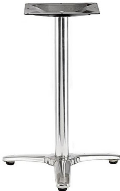
Un piètement fixe moderne et très stable. Usage intérieur et extérieur. Fabriqué en inox. Finition inox miroir. Equipé de vérins de réglage. Poids additionnel de 4 kg. Dims (cm) : L 51 X P 51 X H 72. Plateau maxi D70 ou 70x70
