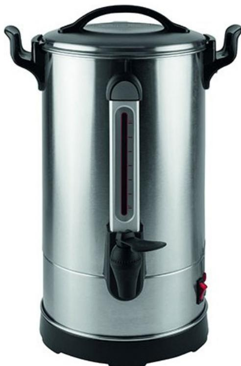
Des percolateurs à café performants et économiques. Couvercle de sécurité et filtre inox permanent. Corps en inox avec double paroi. Fonction cafetière et maintien au chaud. Doubles résistances de chauffe séparées. Temps de préparation pour 11 L : 65 minutes. Robinet anti-gouttes professionnel. Indicateur de niveau de remplissage visuel. Alimentation 230 V. Modèle 100 tasses : 10,8 L / Conso 1,6 kW. Dims (cm) Diam. 26 X H 49.
