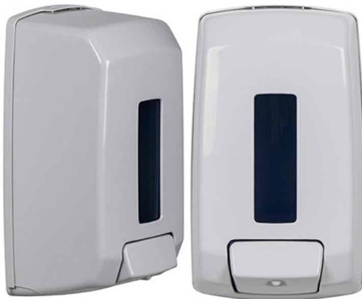
Un distributeur en ABS avec additif antistatique, sécurisé et pratique. Utilisation simple avec bouton poussoir. Repère de consommation. Utilisation de tous types de savon sauf micro billes et gel hydroalcoolique. Réservoir plastique intérieur. Ouverture sécurisée à clé. Dims (cm) : L 13 X P 9,5 X H 22,5. Poids : 0,39 kg.
