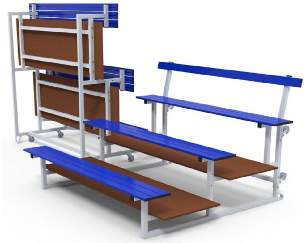
Tribunes mobiles 3 rangs en acier 40x40x1,8 mm plastifié blanc. Lisses et dossiers en alu 80x20 mm plastifié bleu. Plancher en bois antidérapant. Munies de 4 roues pivotantes Ø 80 mm et à frein afin de faciliter la manutention. Dimensions (cm) : L170 x P180,4 x H117,3. Poids : 114,4 kg. Capacité 12 personnes.
