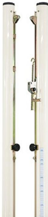
Poteaux de volley entraînement. Fabriqués en tube d'acier galvanisé Ø90x2,1 mm, finition plastifié. Embouts en plastique. Tension par treuil à crémaillère situé vers l'extérieur du terrain, avec manivelle. Fourreaux non inclus. Poulie alu Ø 30 mm. Poignée de serrage. En option, nous consulter : fourreaux.
