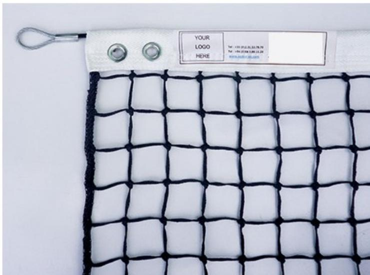
Filet de tennis avec régulateur. Fabriqué en polyéthylène tressé 3 mm haute densité traité UV. Maille simple. Bande haute en tissé avec 4 roues de couture. Câble en acier galvanisé gainé 5 mm. Régulateur en polyester. Dims (m) : 12,70 x 1,07.
