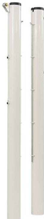
Poteau de tennis conforme NF EN 1510. Poteaux à sceller en acier galvanisé de diamètre 90 mm, plastifié blanc. Poteaux livrés avec leurs barres de cadrage pour fixation du filet (barres verticales sur la hauteur du poteau). Treuil et manivelle inclus. Fourreaux non inclus. Hauteur hors sol 107 cm. En option, nous consulter : fourreaux.
