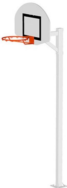
But de basket 90 x 90 mm. Déport : 0,6 m. Tube en acier galvanisé et plastifié pour assurer la résistance à la corrosion. Livré avec panneau en fibre de verre, cercle standard et filet polypropylène 5 mm. Ce but est doté de fixations pour installer le support panneau soit à 3,05 soit à 2,60 m. A sceller.
