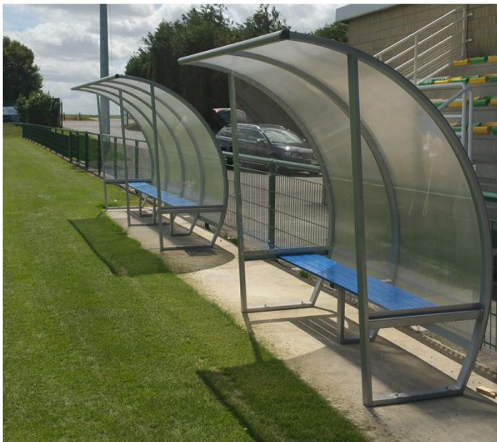
Abris de touche avec structure aluminium plastifié. Ossature principale en 60x30x2 mm. L'assise se compose de 3 lisses en tube d'aluminium section 20x80x2,5 mm. Profil arrondi en partie haute. Les cotés sont dotés de protections transparentes résistantes aux impacts de ballons en polycarbonate 2 mm. Protection arrière en polycarbonate 5 mm. Embouts de protection en PVC. A sceller. Dims (cm) : L350 x H160. Capacité : 7 joueurs.
