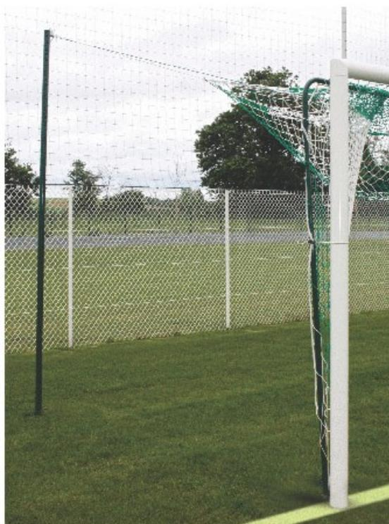
Système de relevage du filet en tube galvanisé diamètre 27x2 et 34x2 mm. Plastifié vert. Crochet passe fil diamètre 4 mm. Cordeau avec boucle. S'adapte au but de foot à 8 et à 11 joueurs. Réglable en longueur de 5 m à 7,43 m et en profondeur de 1,55 à 2,83m.
