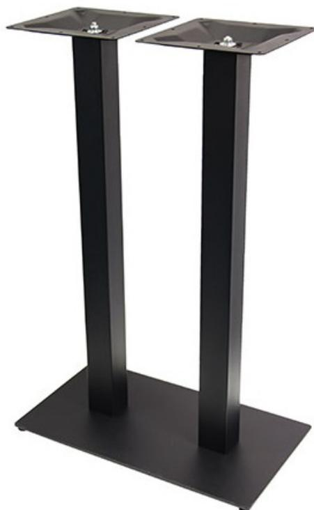
Piètements fixes en acier pour un usage intérieur. Finition peinture époxy noire. Hauteur du pied : 108 cm. Base rectangle 40 X 70 cm, en acier assurant la stabilité de la table. Equipés de vérins de réglage. Platines de fixation pour les plateaux, 30 X 30 cm. Poids : 26,7 kg.
