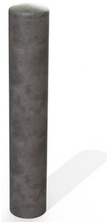
Indispensable pour la sécurisation des abords des bâtiments. Fabriquées en acier galvanisé à chaud. Corps en tube d'acier de Ø 22 cm X ép 4 mm. Chapeau à sceller en tôle ép. 2,5 mm. Finition galvanisé brut. A sceller dans plot béton. Scellement de 33,3 à 53,3 cm. Hauteur 153 cm. Poids : 31 kg.
