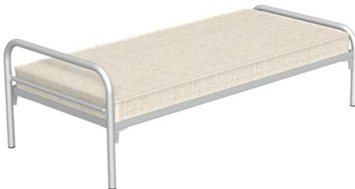
Lit tout métal avec sommier panneau. 2 montants en tube acier Ø 40 x 1.5 (tête et pied de lit identiques). 4 embouts ? 40 en polypropylène, non tachants. La tête et le pied de lit sont munis de supports de cadre sommier en feuillard acier 50 x 1.5mm, soudés sur les pieds. Blocage par 4 vis M6 + écrous borgnes. Revêtement poudre thermodurcissable à base d'époxy et de polyester. Coloris au choix nous consulter. Garantie 2 ans.
