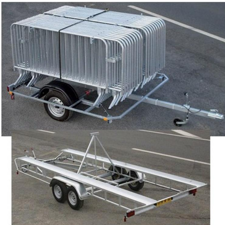
Remorque non freinée, tractable avec un permis B (selon véhicule). Stockage des barrières par les côtés pour un chargement et déchargement plus facile. Remorque compacte et maniable. Dims (cm) : L 3,57 X P 2,05. Poids : 750 kg. Charge utile 575 kg. Capacité : 38 barrières 14 barreaux.
