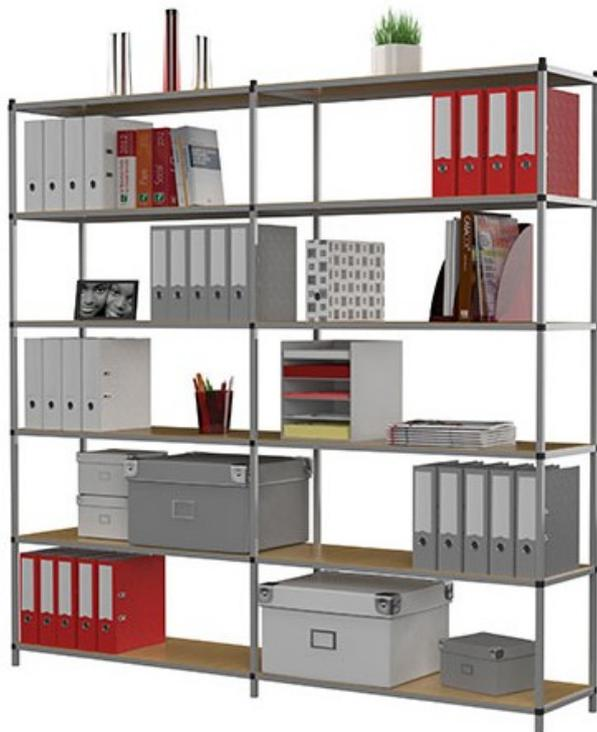
Rayonnage de classement pour le bureau ou les réserves. 6 niveaux pour classeurs à levier. Structure en acier 10/10èmek, finition peinture époxy grise. 6 tablettes avec isorel, ép. 3 mm. Intervalle entre tablettes : 36 cm. Charge utile jusqu'à 80 kg par tablette. Livré à plat, montage facile par simple emboîtement. Possibilité d'ajouter un ou plusieurs éléments pour constituer des rayonnages illimités. Dims (cm) : L100 x P34 x H200. Garantie 5 ans.
