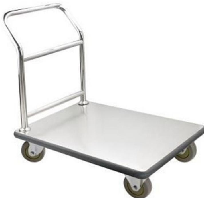
"• Matériau(x) : Acier inoxydable • Protection latérale en caoutchouc • 4 roulettes • Charge admissible:150 kg • Poids net: 20kg• Dim .: L 900 x P 600 x H 900 mm"
