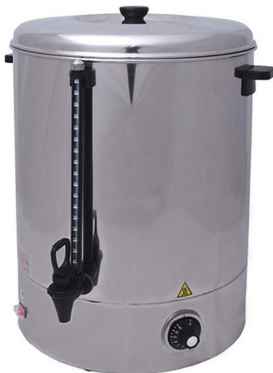
"• Capacité: 40 litres. • Idéal pour le chauffage et de maintien au chaud de l'eau, du café, du thé • Acier inoxydable • Contrôle de la température: +30° / +110°C • Lampes de contrôle (chauffage / maintien au chaud) • Protection contre la surchauffe • Dim .: Ø 390 x H 600 mm • Alimentation: 230 V / 1 HP / 2,4 kW"
