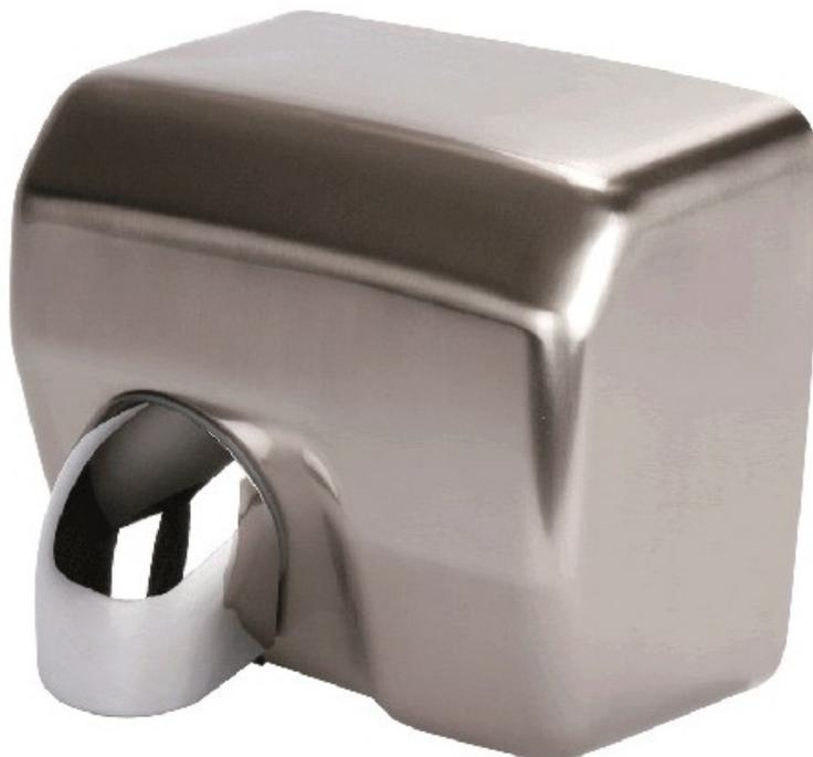
Sèche-main robuste particulièrement efficace et économique. Capot en inox, antivandalisme, épaisseur 2 mm. Déclenchement automatique par cellule. Buse pour la concentration de l'air. Arrêt automatique en cas de surtension. Temps de séchage 15 secondes. Puissance 2500 W. Niveau sonore : 70 dB. Livré avec son kit de fixation murale. Dims (cm) : L27 X P20 X H24. Poids : 6,25 kg. Garantie 3 ans.
