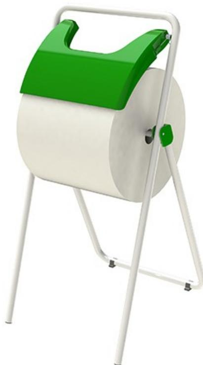
Découpe facile du papier : scie en plastique intégrée dans le couvercle et maintenue par pression par 2 ressorts latéraux. Changement facile des bobines. Structure en tube métallique diamètre 20 mm, finition peinture époxy blanc. Couvercle en ABS vert.
