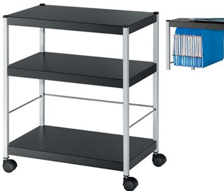
Structure en tube métal laqué époxy coloris aluminium 20x20, épaisseur 2 mm. Plateau métal laqué noir épaisseur 0.8 mm. Équipé de replis pour recevoir des dossiers suspendus. Galerie chromée pour le maintien des dossiers et des classeurs. Charge utile : jusqu'à 35 Kg par plateau. 4 roulettes multidirectionnelles. Livrées à plat.
