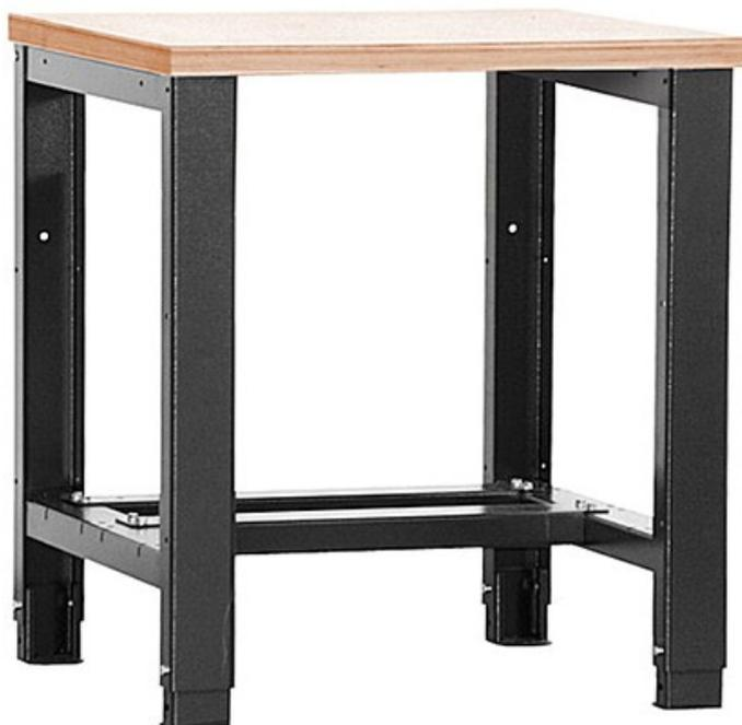
Etabli lourd adapté aux professionnels ayant plus de contraintes techniques notamment de charges. La charge max. 450 kg. Structure en tôle d'acier 30/10ème. Tube section 90 x 50 mm. Longérons 90 x 50 mm. Hauteur réglable à 85 ou 90 mm. Piétements avec équerres pour fixation sol. Finition peinture époxy cuite au four à 180°C. Plusieurs coloris au choix. Plateau bois feuillus vernis, épaisseur 40 mm. Charge maxi 450 kg. Dims (cm) : L80 x P70 x H85/90.
