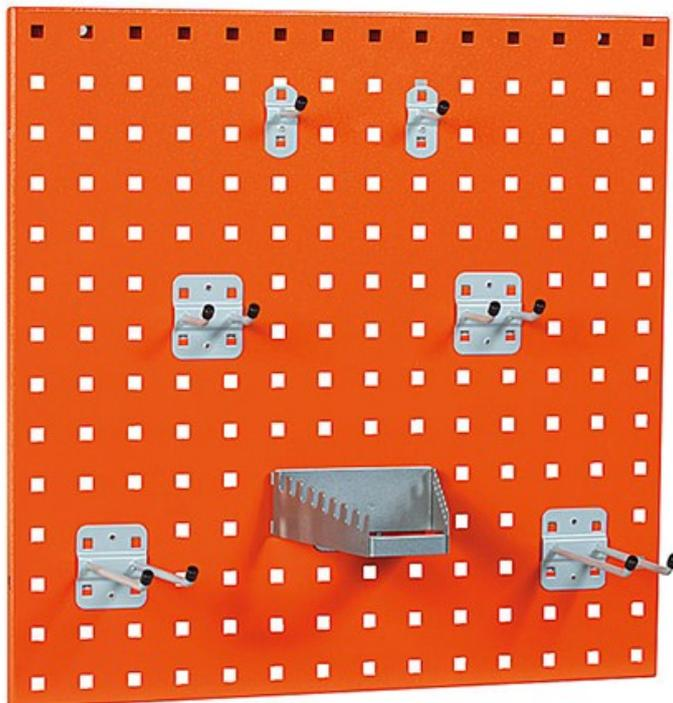
Ces accessoires permettent de personnaliser de manière pratique et utile vos établis légers. Panneau perforé en tôle d'acier 8/10ème. Finition peinture époxy cuite au four à 180°C. Plusieurs coloris au choix. Perforations carrées 10x10 mm au pas de 38 mm. A fixer sur le mur. Dims (cm) : L53,2 x H53,2.
