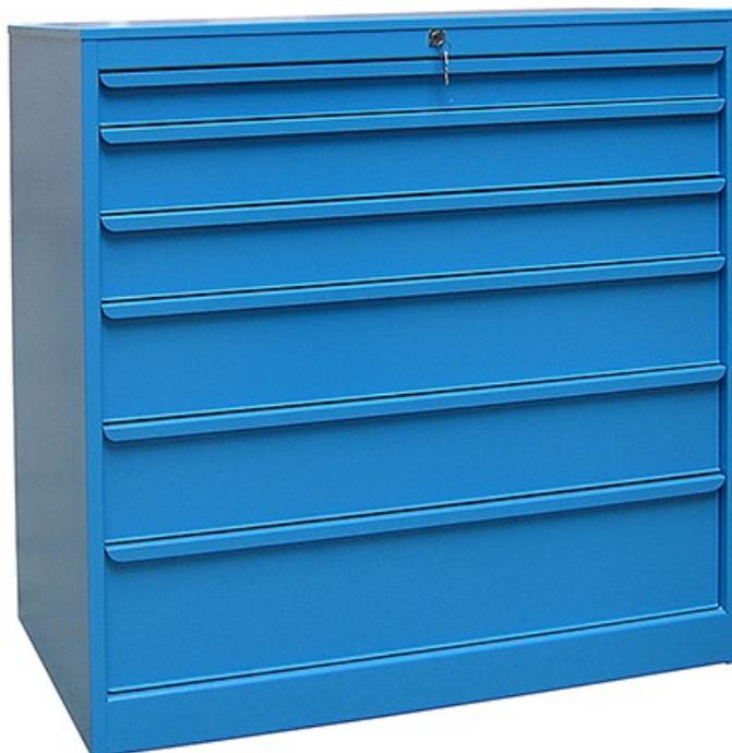
Les armoires d'atelier à tiroirs sont équipées de glissières télescopiques et d'un système anti-basculement. La fermeture est centralisée (avec clé). Chaque tiroir peut être aménagé avec des séparateurs (vendus en option). Construction monoblocs soudées, corps et tiroirs en tôle d'acier 12/10ème . Finition peinture époxy, cuite au four à 180°C. Coloris bleu RAL 5012. Charge max : 75 kg/tiroir). Modèle 6 tiroirs : 1 x 75 mm, 2 x 125 mm, 2 x 175 mm, 1 x 225 mm. Dims (cm) : L100,5 x P59 x H105,2.
