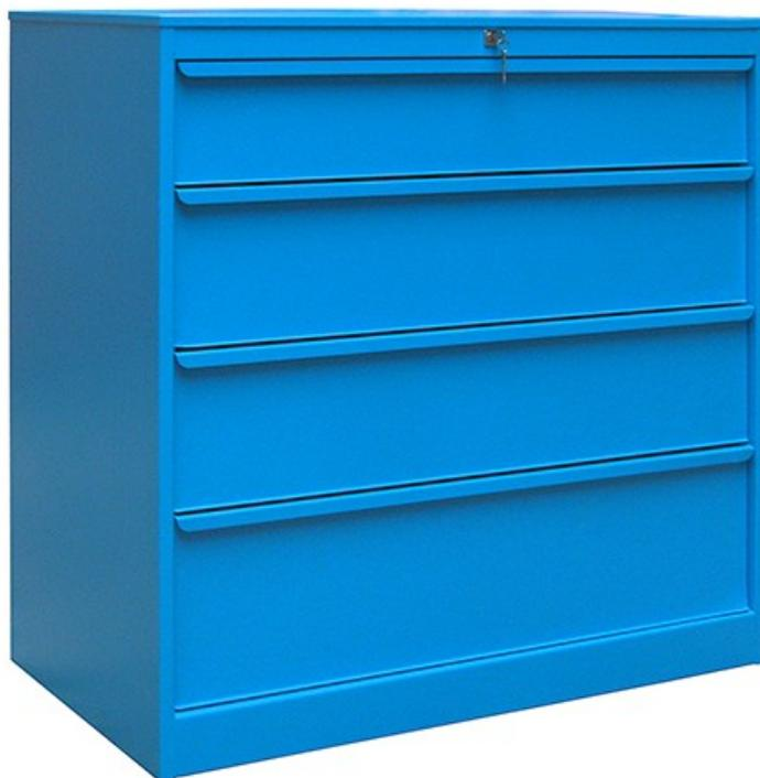
Les armoires d'atelier à tiroirs sont équipées de glissières télescopiques et d'un système anti-basculement. La fermeture est centralisée (avec clé). Chaque tiroir peut être aménagé avec des séparateurs (vendus en option). Construction monoblocs soudées, corps et tiroirs en tôle d'acier 12/10ème . Finition peinture époxy, cuite au four à 180°C. Coloris bleu RAL 5012. Charge max : 75 kg/tiroir). Modèle 4 tiroirs : 1 x 75 mm, 2 x 225 mm, 1 x 275 mm. Dims (cm) : L100,5 x P59 x H105,2.
