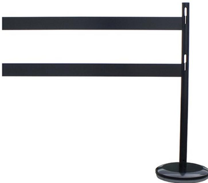
Poteaux et barrières en acier. Poteaux H 1000mm, tube diam 50mm. Barrière 1110x80mm, épaisseur 20mm. Encombrement 1350 mm.
