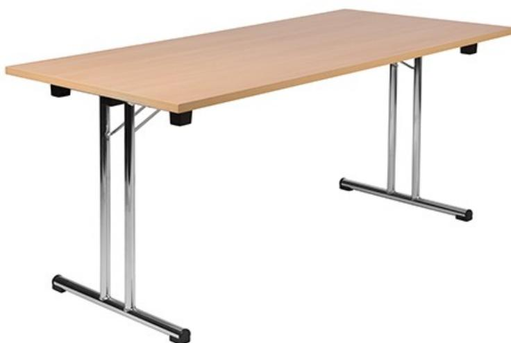
Structure tube Ø 30x1,5 mm. Plateau mélamine 22 mm - chants ABS. Butée d'empilage pour la protection du plateau. Taille: 6. Nuancier au choix.
