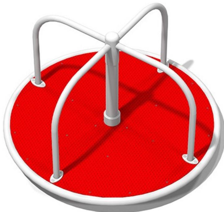
Certifié selon la Norme Européenne EN 1176 par l'institut allemand TÜV. Tourniquet en acier galvanisé recouvert au sol de polyéthylène. Grâce à ce système le tourniquet est anti-dérapant. De plus il ne chauffe pas l'été et n'est pas gelé pendant l'hiver. Une option en plancher métallique est disponible. Espace Minimum : 560 x 560 cm Hauteur de chute : 80 cm Zone de chute : NC Dimensions hors tout : Ø 130 x 80 h cm
