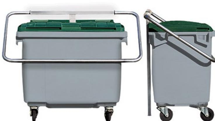
Protège conteneur à levier. Fabriqué en inox 304L, arceau diamètre 40 x 2 mm, tube central section 80 x 40 mm. Pour conteneur jusqu'à 1000 L. Dims (cm) : L 145 X H total 150. A sceller, profondeur au choix (15 à 20 cm).
