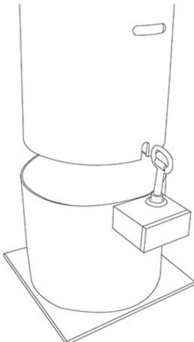
\* Produit optionnel, vendu uniquement avec le produit auquel il s'associe. Système d'amovibilité avec verrouillage par clé triangle. Convient aux bornes Orthez.
