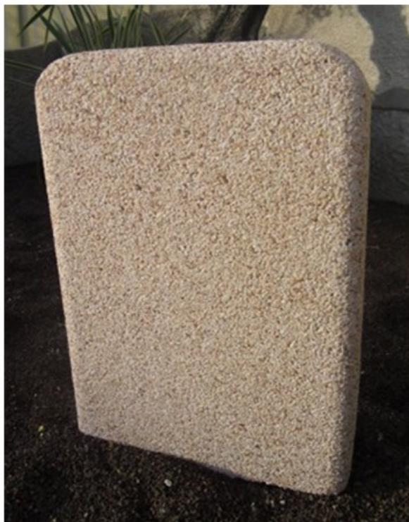
Borne type kilométrique, esthétique, robuste et pratique pour limiter les accès. Fabriquée en béton désactivé. Finition type gravillon lavé : Cerdagne. A sceller. Dims (cm) : L43 X P15 X H70. Poids : 162 kg.
