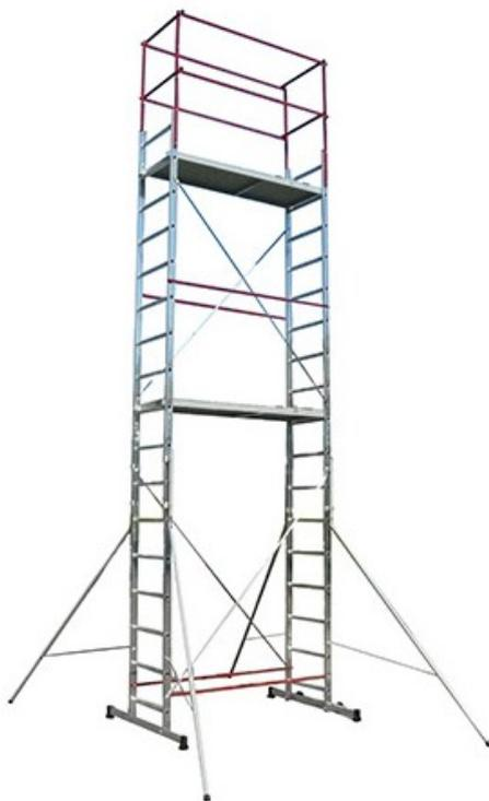
Echafaudage aluminium roulant NIMBUS 500. Mobile Conforme à la norme E85-200 classe B Section de montants: 60x24cm Plateau confortable 150x50 Garde-corps périmétrique Avec lisses et sous-lisses. Poids: 80kg
