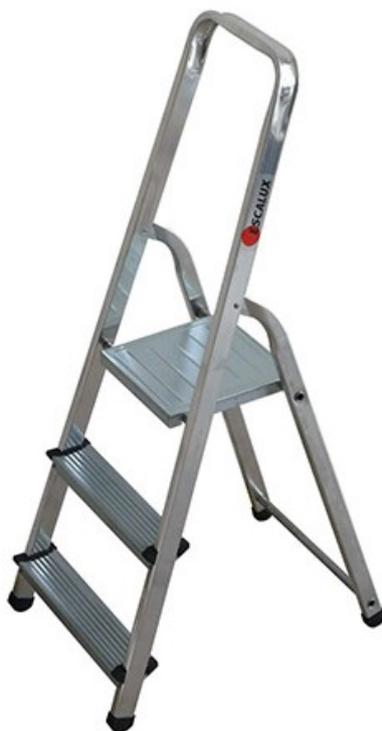
Escabeau ménager de sécurité ALUMIXTE structure en Alu Plateforme en acier zingué Marches antidérapantes en acier zingué Chaussures à 150 kg, testé à 260 kg. Articulations par crosses monoblocs Embouts antidérapants interchangeables
