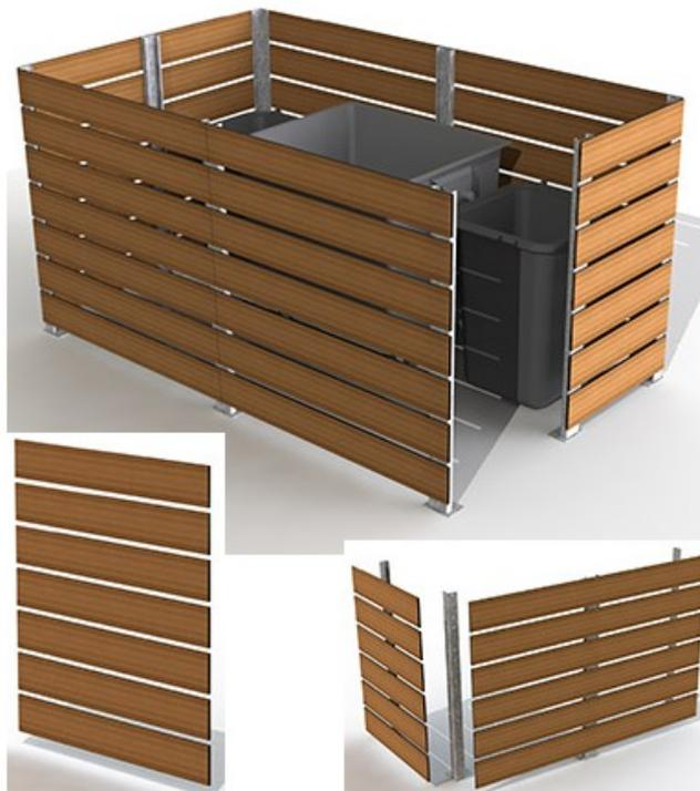
Lames en stratifié compact épaisseur 14mm, aspect Teck. Modules de 1.50 M permettant de s'adapter à tous type de poubelles. Longueur 1,50M Nb.lames 7 Hauteur 1,57M Poids 38.9 KGÀ boulonner sur poteau.Poteaux vendus séparément, nous consulter.
