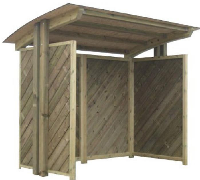
Abri sur ossature à deux pieds. Poteau section 100 X 100 mm. A sceller (surlongueur prévue de 50 cm). Panneaux de côté construits avec des poteaux de section 70 X 70 mm et habillés avec des lames de 140 X 28 mm. Toiture cintrée sur poutres lamellé-collé. Couverture en shingle sur panneau CTBX, coloris vert (autres coloris sur demande : noir ou brique). Dimensions intérieures : 260 X 138 cm. Dimensions hors tout : 283 X 180 cm.
