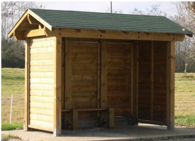
Tout le charme d'un abri traditionnel en bois avec une structure de type charpente. Ensemble fabriqué en pin traité autoclave classe IV, sans chrome ni arsenic. Abri livré avec une banquette. Poutres en lamellé collé. Panneaux de côté en clin de 22 mm. Couverture en shingle. Poteaux de section 12 X 12 cm. Traverses hautes de 14 X 6 cm. Panneaux latéraux de 131 X 4,4 cm. Assise banquette intérieure 152 cm.
